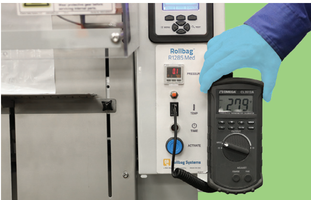
Monitoreo de temperatura en una embolsadora automática R1285 Med.
